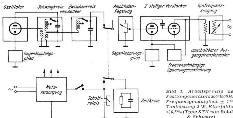
Bild 1. Arbeitsprinzip des Festtongenerators 800/1000 Hz; Frequenzgenauigkeit ± 1‰, Tonleistung 2 W, Klirrfaktor < 0,5‰ (Type STK von Rohde & Schwarz)
