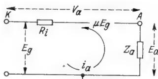
Bild 2. Ersatzschema für die Schaltung nach Bild 1
