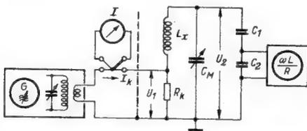
Bild 147. Gütefaktormessung nach dem Quotientenverfahren mit galvanischer Sender-Meßkreis-Kopplung
