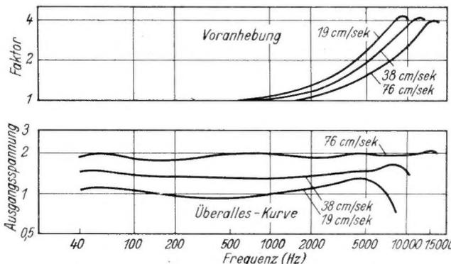
Bild 6. Voranhebungs- und Über-Alles-Kurven der Schaltung nach Bild 5
