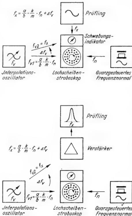
Bild 9. Frequenzmessung an Wechselstromerzeugern (Generatoren), oben, und an Wechselstromverbrauchern (Indikatoren), unten, mittels Hilfe einer quartz-gesteuerten Niederfrequenz-Eichanlage; schematische Darstellung
