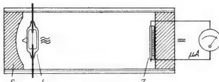
Bild 5. Konstruktion des Hf-Foto-Milliamperemeters
