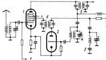
In der Schaltung (Bild) ist 1 eine Verstärkerröhre, in der die Empfangsfrequenz und die Zwischenfrequenz verstärkt werden. 2 dient als Oszillator- und Mischröhre. Die im Anodenkreis der Röhre 1 am Kreis 4 auftretende Empfangsspannung wird der in der Frequenz des Kreises 3 schwingenden selbst-erregten Röhre 2 zugeführt und die Zwischenfrequenz über die Kreise 6 abgenommen. Die Zwischenfrequenz wird in 1 verstärkt und über das Bandfilter 6 abgenommen.
