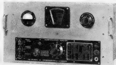
Bild 8. Stroboskop-Frequenzmesser von vorn. Oben Mitte: Einblickfenster mit Schlitzscheibe dahinter, links Schwebungsinstrument. Rechts unten: Anwahltablette für die Normalfrequenzen als Eichpunkte
