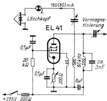
Bild 4. Löschkopf-Schaltung
