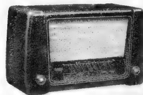
UF 41, UBC 41, UL 41, Selen, besitzt eine übersichtliche Flutlichtskala, perm.-dynamischen 3,5-Watt-Lautsprecher von 180 mm Ø, Baß- und Diskanthebung, zwei-stufigen Schwundausgleich, Zf-Saugkreis und beim Allstromgerät für Wechselstrom Spannungsverdopplung. Preißgehäuse 34 x 22 x 17 cm. Preis 189.— DM.
