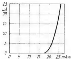
Bild 4. Kennlinie des Foto-Milliamperemeters
