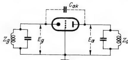
Bild 1. Das Prinzip der Gitterbasisschaltung
