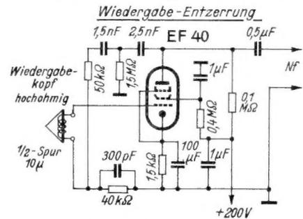
Bild 7. Entzerrerschaltung für ein Tonbandgerät mit einer Bandgeschwindigkeit 19 cm/sek
