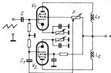
Bild 83. Gegentaktschaltung zur Stromablenkung
