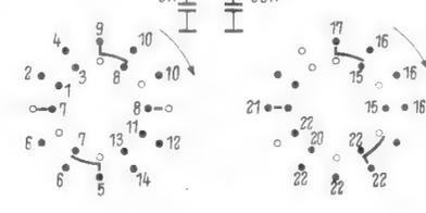
Spannungen gemessen mit Instrument 833 Ω/V
