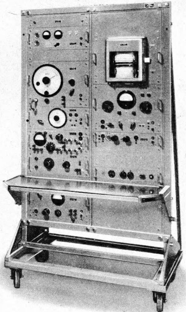
Zur automatischen Registrierung von frequenzabhängigen Dämpfungen und Scheinwiderständen aller Art, z. B. Lautsprecher, Mikrofone, Schallspeichergeräte, Rundfunkempfänger
